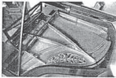
使用されている鉄骨にも、プレイエルの深いこだわりが、錆蝕(ちゅうつ)後、内部のゆがみをとるために約1年間外気にさらしたものを扱う。
